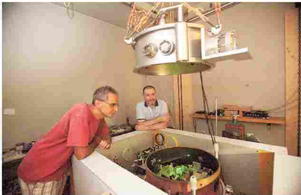
L'apparato sperimentale dell'INRiM per la misura della distanza interatomica degli atomi di silicio
