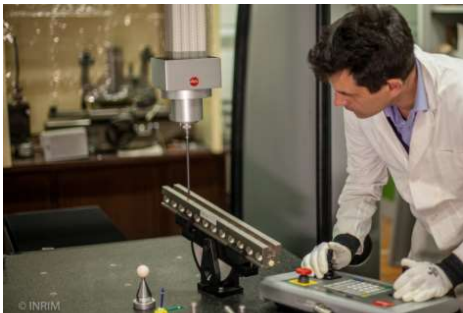
Macchina di misura a coordinate nei laboratori INRiM
