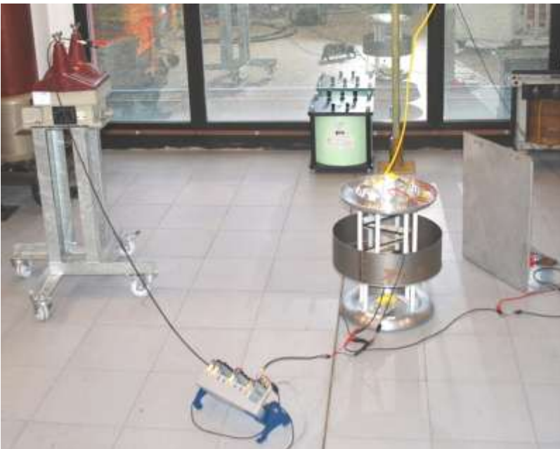
Laboratorio INRiM per la taratura dei trasduttori di tensione
