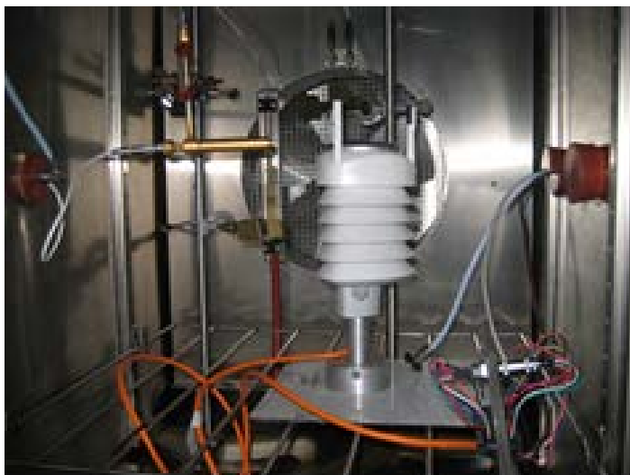
Installazione sperimentale per taratura di centraline meteorologiche
