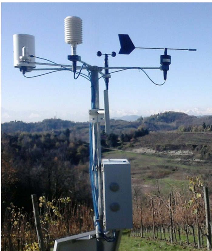
Centralina meteorologica automatica (AWS) tarata nei laboratori INRIM e installata in un sito agricolo
