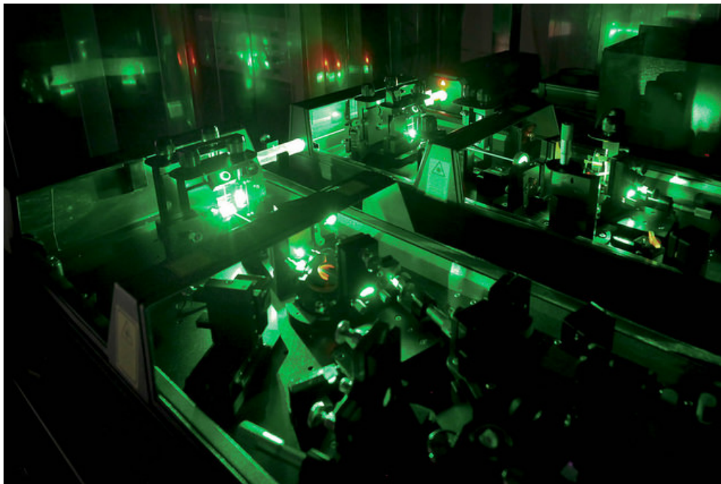
Sistemi laser utilizzati per la generazione di stati quantistici a singolo fotone per la metrologia e la comunicazione quantistica
