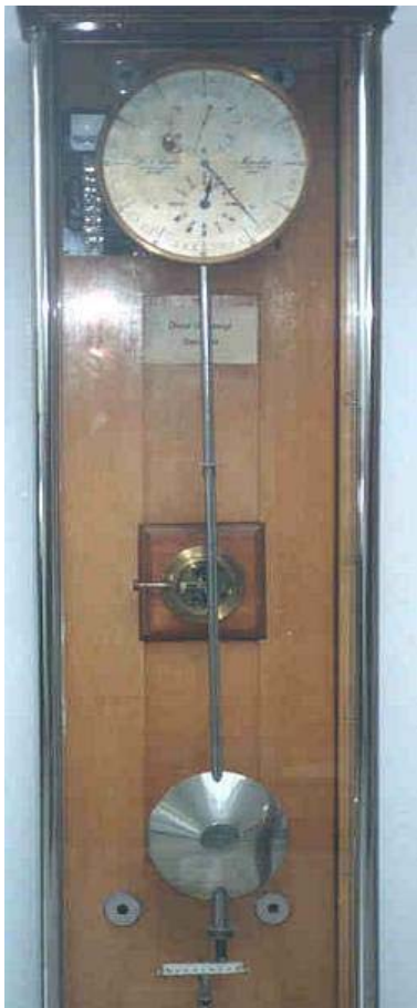
5 Pendolo ad oscillatore libero di Shortt
