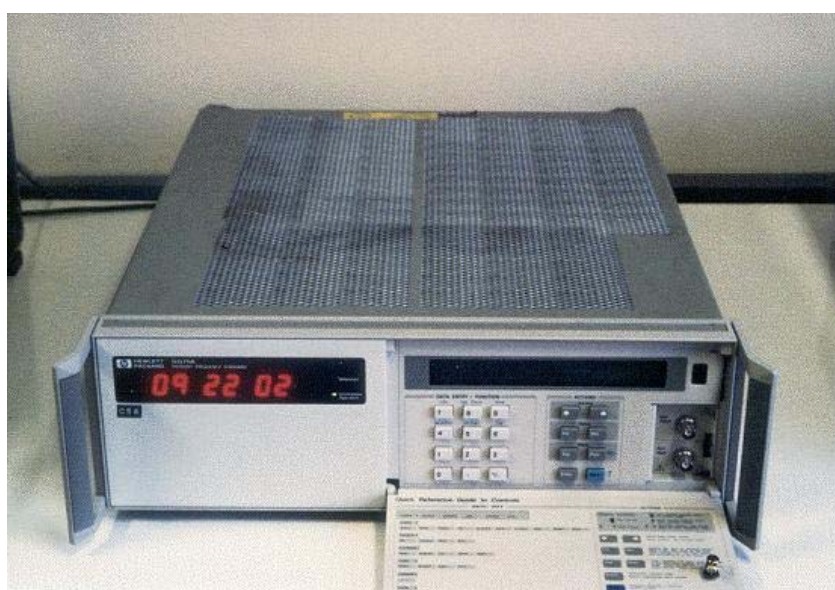
Campione a fascio di cesio Hewlett Packard mod. 5071A
